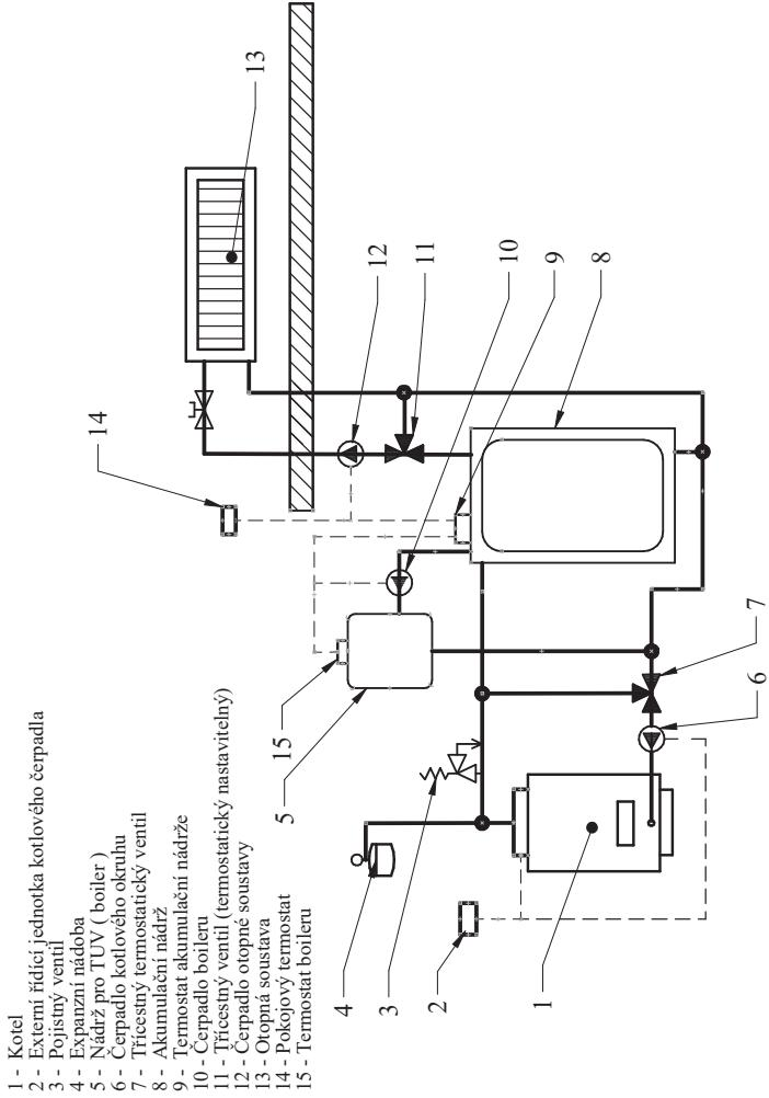
Zapojení s akumulační nádrží umožňuje akumulovat přebytek tepla v zásobníku k pozdějšímu vytápění.
