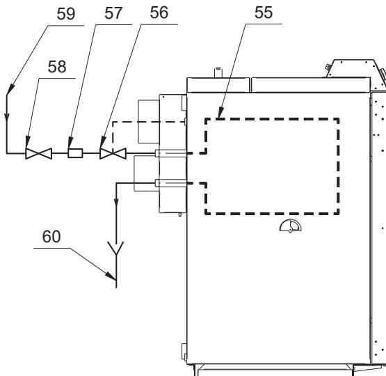
obr. 5 Připojení bezpečnostního ventilu ke kotli PYRO THERM
